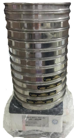
ภาพที่ 1 ตะแกรงทดสอบที่มีขนาดเส้นผ่านศูนย์กลาง 4.75, 4.0, 3.35, 2.8, 2.0, 1.4, 1 และ 0.5 มิลลิเมตร เรียงเป็นชั้น ตามลำดับบนเครื่องสั่น
