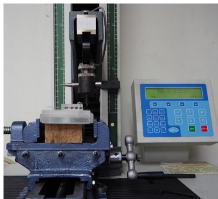
รูปที่ 4 วัดแรงกดจากลวดนิกเกิลไทเทเนียมด้วยเครื่องทดสอบอินสตรอนยูนิเวอร์แซล Figure 4. Measurement of unloading force by Instron universal testing machine
