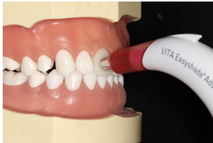
รูป 2 การวัดสีฟันของเครื่องสเปกโตรโฟโตมิเตอร์โดยใช้เครื่องวัดสีซีเจเนดแอดวานซ์สีจุดศูนย์กลาง Figure 2 Spectrophotometric tooth color determination using VITA Easysshade Advance 4.0
